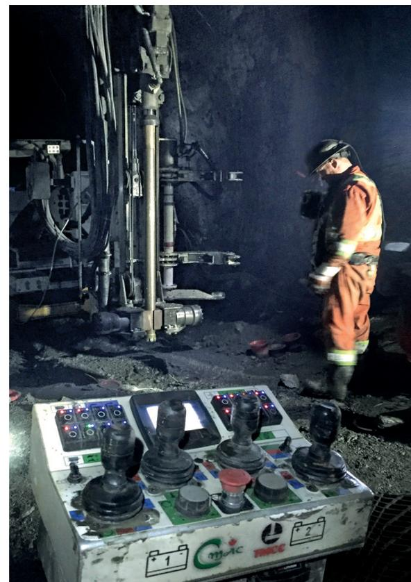
Production Master 2.3 - это самоходная буровая каретка для бурения длинных параллельных отверстий в кровле и почве, а также для веерного бурения и периферийного бурения вертикально или под заданным углом. Бурение с верхним ударником обеспечивает возможность бурения отверстий в диапазоне 64-165 мм в зависимости от конфигурации.
