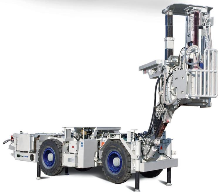
Удержание кровли горных выработок и туннелей с помощью анкерной крепи является одним из направлений создания буровых машин компании Mine Master.
